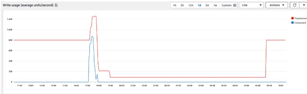
放大图片，我们可以看到，应用程序中有一个高峰，它触发了 70% 自动缩放阈值，迫使自动缩放启动，来为表提供所需的额外容量。预定的自动缩放操作将影响最大值和最小值，设置这些值是您的责任。
