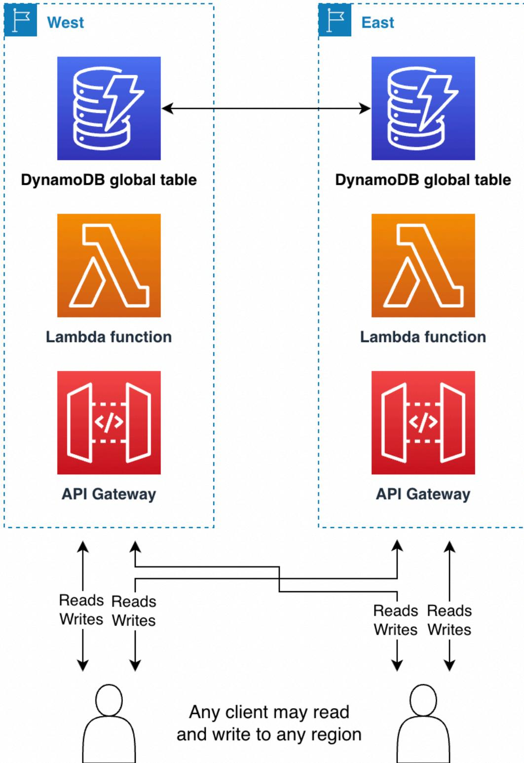
写入任何区域模式是实现起来最简单的架构。路由更容易，因为任何区域都可以随时成为写入目标。失效转移更容易，因为任何最近的写入操作都可以任意次重播到任何辅助区域。在可能的情况下，您应该针对这种写入模式进行设计。
