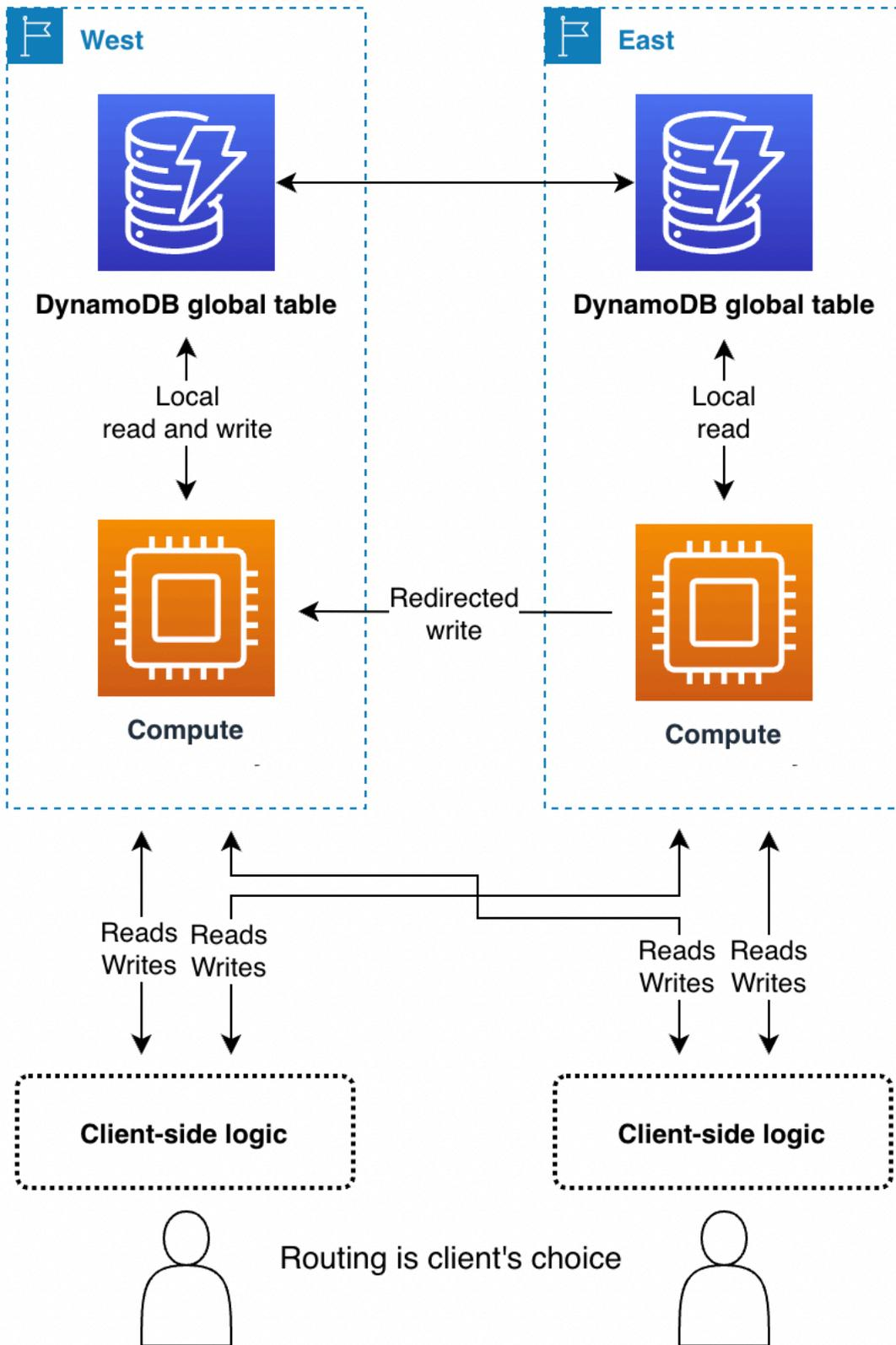
客户端驱动的请求路由的优势在于，它可以适应现实世界中的公共互联网流量状况等情况，以便在发现性能下降时切换区域。客户端必须知道所有潜在的端点，但启动新的区域端点并不常见。
