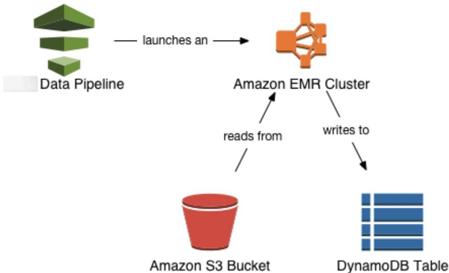
要导出 DynamoDB 表，您可以使用 Amazon Data Pipeline 控制台创建新的管道。管道将启动 Amazon EMR 集群以执行实际导出。Amazon EMR 从 DynamoDB 读取数据，将数据写入 Amazon S3 存储桶中的导出文件。
