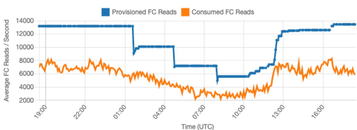
由于给定时段或一天内的流量更加稳定，我们可以将表的预置容量设置为相对接近于表的实际使用量。预置容量表的成本优化过程归根到底是一个练习的过程，即在不增加表上 `ThrottledRequests` 的情况下，让预置容量（蓝线）尽可能靠近使用容量（橙线）。两条线之间的空间既是容量浪费，又是避免节流导致用户体验欠佳的保障。
