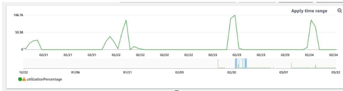
此时，您可能获得与本例中的图片不同的结果。这完全取决于您的工作负载中的数据。利用率超过 100% 的间隔容易导致节流事件。DynamoDB 提供[容量暴增](#)，不过一旦容量暴增，任何超过 100% 的流量都将被节流。
