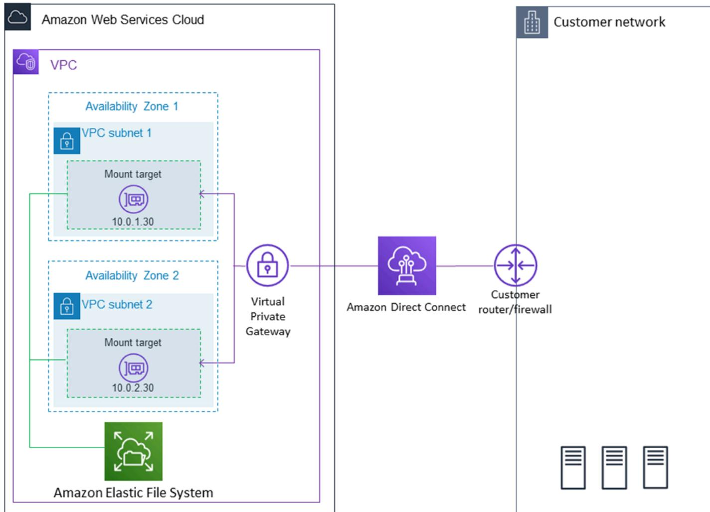
如果您能通过本地服务器和 VPC 之间的 Amazon Direct Connect 连接到达挂载目标的子网，则可以使用您的 VPC 中的任何挂载目标。要从本地服务器访问 Amazon EFS，请向挂载目标安全组添加规则，以允许从本地服务器进入 NFS 端口（2049）的入站流量。有关更多信息，包括详细步骤，请参阅[先决条件](#)。
