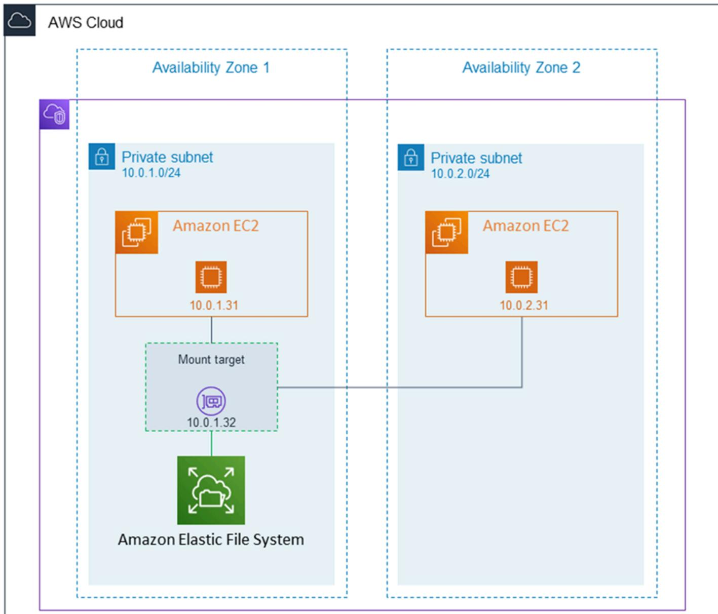
在此图中，VPC 有两个可用区，每个可用区都有一个子网。由于文件系统类型为单区，因此它只能有一个挂载目标。为了提高性能和降低成本，我们建议您从挂载目标访问文件系统，该挂载目标与您要挂载文件系统的 EC2 实例位于同一个可用区。
