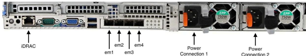
带有网络和电源连接器标签的硬件设备一背面。
