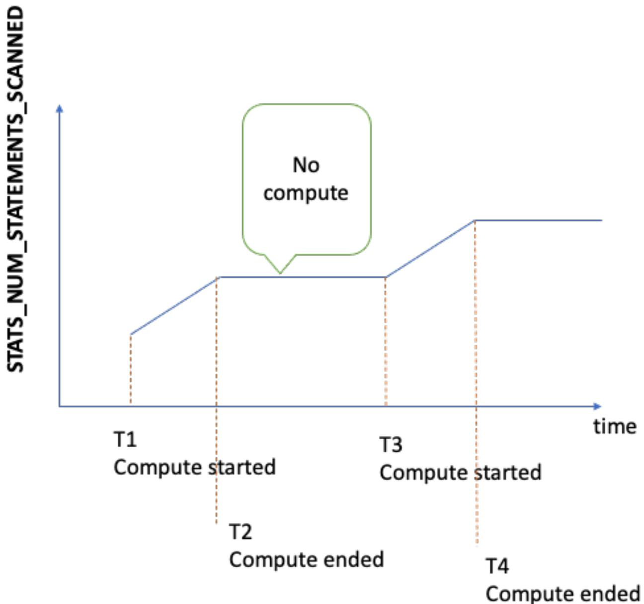
发生计算时，图形的斜率显示出速度有多快（斜率越陡，计算统计数据的速度就越快）。
