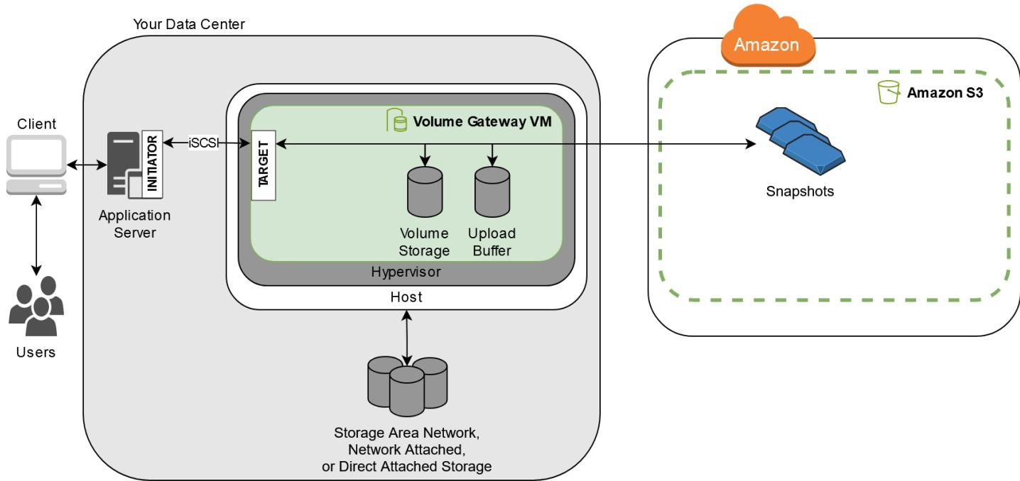
在数据中心的主机上安装并激活 Storage Gateway 软件设备 (VM) 后，您可以创建网关存储卷。然后将它们映射到本地直连式存储 (DAS) 或存储区域网络 (SAN) 磁盘。您可以从新磁盘或已存有数据的磁盘开始着手。您然后可以将这些存储卷作为 iSCSI 设备安装到场内应用程序服务器。场内应用程序从/向网关存储卷读写数据的同时，这些数据从卷的已分配磁盘存储并检索。
