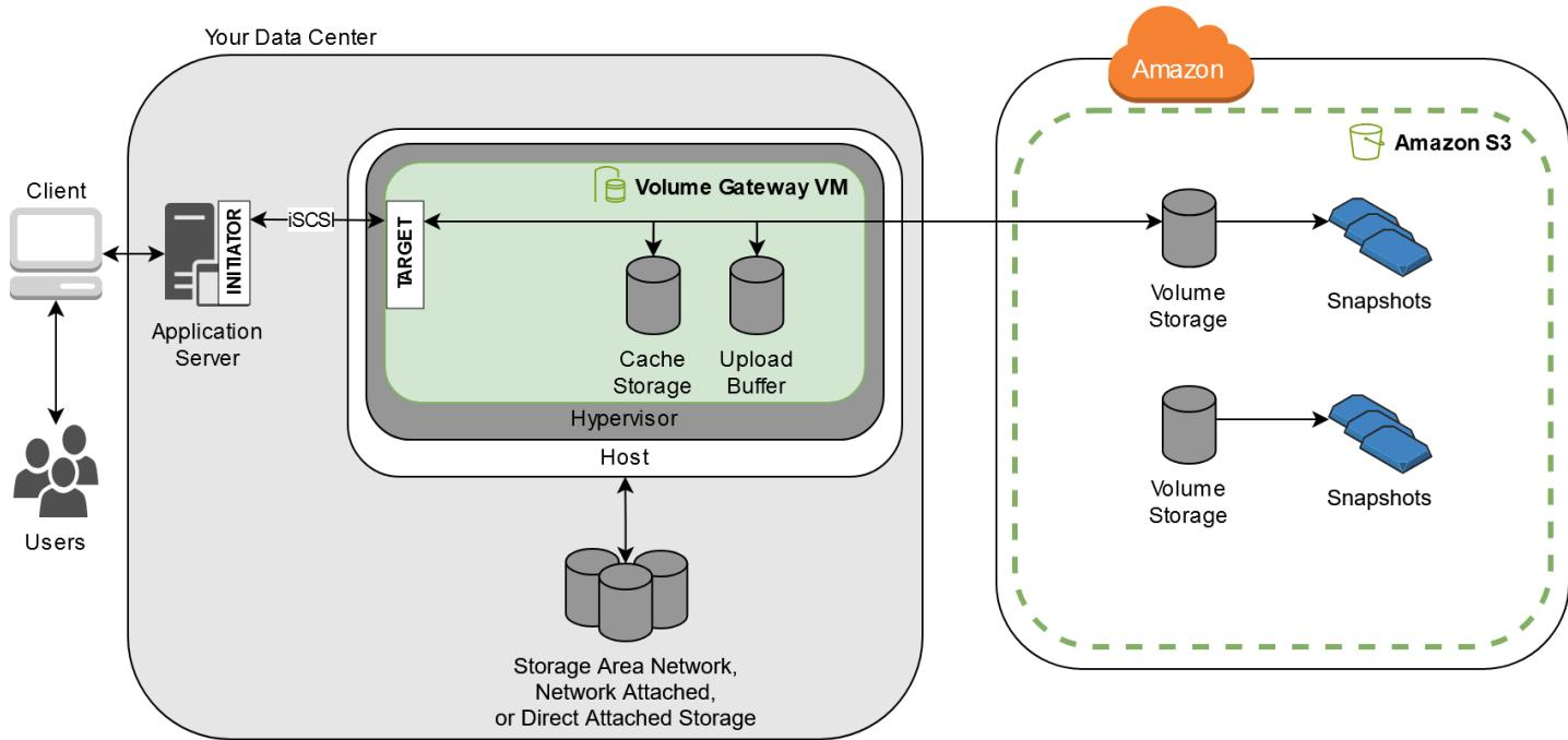
在数据中心的主机上安装 Storage Gateway 软件设备（虚拟机）并将其激活后，您可以使用 Amazon Web Services Management Console 来配置由 Amazon S3 支持的存储卷。您还可以使用 Storage Gateway API 或 Amazon SDK 库以编程方式配置存储卷。您然后将这些存储卷作为 iSCSI 设备安装到场内应用程序服务器。
