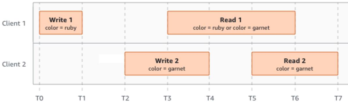
在上一个示例中，W2 在 W1 收到确认之前开始。因此，这些写入被视为并发写入。Amazon S3 在内部使用 last-writer-wins 语义来确定哪个写入优先。但是，由于网络延迟等各种因素，无法预测 Amazon S3 接收请求的顺序和应用程序接收确认的顺序。例如，W2 可能由同一区域中的 Amazon EC2 实例启动，而 W1 可能由距离更远的主机启动。确定最终值的最佳方法是在确认两次写入操作后执行读取。
