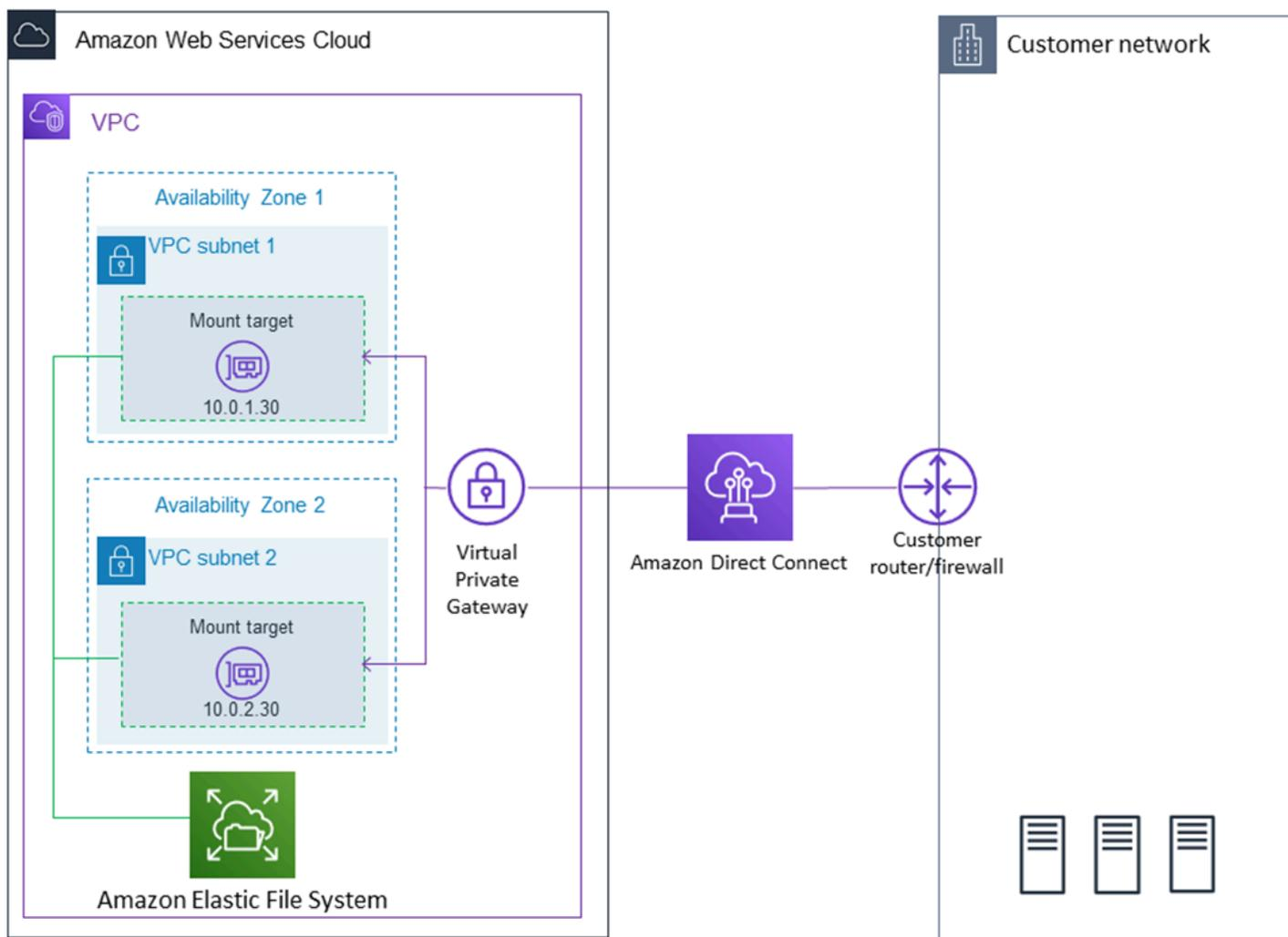
如果您能通过本地服务器和 VPC 之间的 Amazon Direct Connect 连接到达挂载目标的子网，则可以使用您的 VPC 中的任何挂载目标。要从本地服务器访问 Amazon EFS，请向挂载目标安全组添加规则，以允许从本地服务器进入 NFS 端口 ( 2049 ) 的入站流量。有关更多信息，包括详细步骤，请参阅[先决条件](#)。
