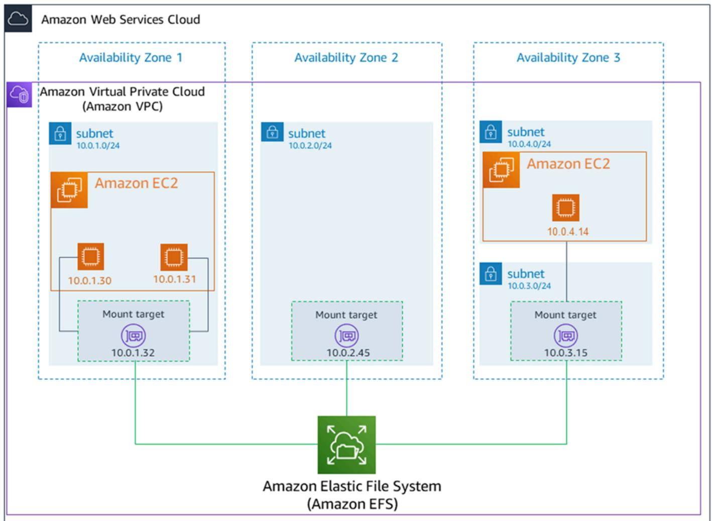
在此图中，虚拟私有云（VPC）有三个可用区。因为文件系统是区域性的，所以在每个可用区中都创建了一个挂载目标。出于性能和成本原因，我们建议您从同一可用区内的挂载目标访问文件系统。其中一个可用区具有两个子网。但是，将仅在一个子网中创建挂载目标。有关更多信息，请参阅 [使用 EFS 挂载帮助程序挂载 EFS 文件系统](#)。
