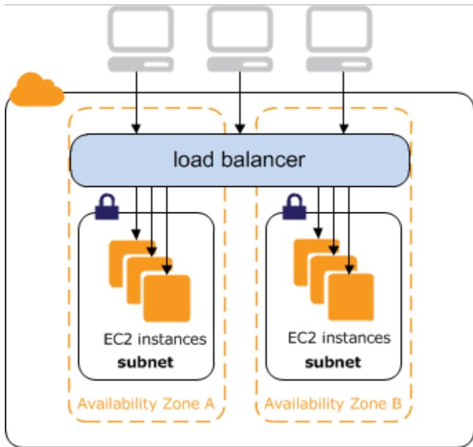
内部负载均衡器的 DNS 名称可公开解析为节点的私有 IP 地址。因此，内部负载均衡器可路由的请求只能来自对负载均衡器的 VPC 具有访问权限的客户端。有关更多信息，请参阅 [内部负载均衡器](#)。
