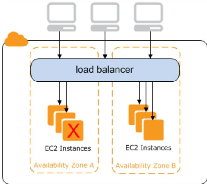
要确保您的注册实例能够处理每个可用区中的请求负载，每个可用区中向负载均衡器注册的实例的数量必须大致相同。例如，如果您在 us-west-2a 可用区中有十个实例，在 us-west-2b 可用区中有两个实例，则请求将在两个可用区之间平均分配。因此，us-west-2b 中的两个实例便会与 us-west-2a 中的十个实例承担相同的流量。应改为每个可用区中有六个实例。
